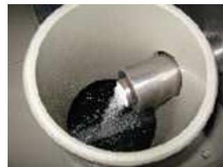
При осаждении грязи или сухой пыли, а также при образовании грязевой корки на внутренней поверхности смесителя необходимо открыть крышку смесителя и протереть внутреннюю поверхность смесителя сухой салфеткой или ветошью.
